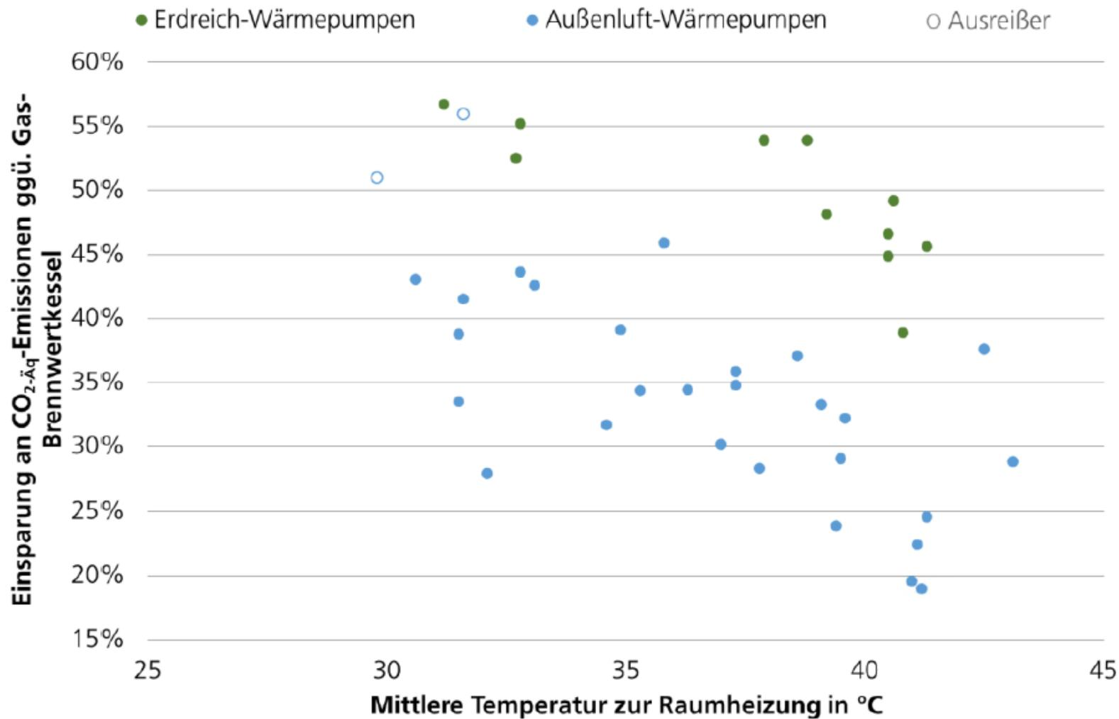
Abbildung 65: CO<sub>2</sub>-Äq-Emissionen von 29 Außenluft-Wärmepumpen und 12 Erdreich-Wärmepumpen im Vergleich zu einem Gas-Brennwertkessel in Abhängigkeit von der mittleren Temperatur zur Raumheizung bezogen auf das Jahr 2018
